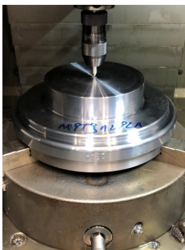
Figura 86 - Alinhamento com o ponto (1º passo)
