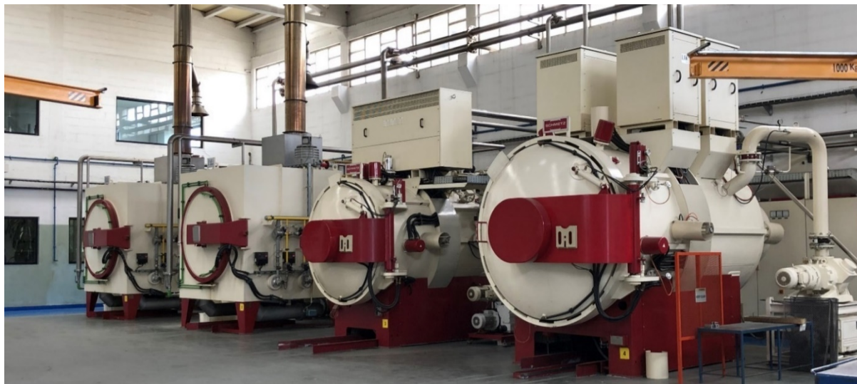
Figura 52 - Fornos para tratamentos térmicos
