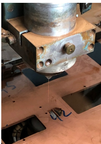
Figura 62 - Eletroerosão de fio, Elétrodos de cobre
