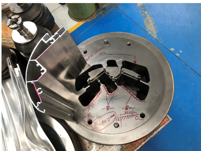
Figura 69 - Perfil extrudido e macho
