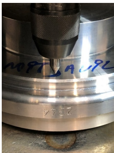
Figura 88 - 2º passo - Percorrer a peça, verificando o ponto na linha
