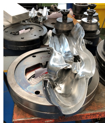
Figura 70 - Perfil empenado e placa
