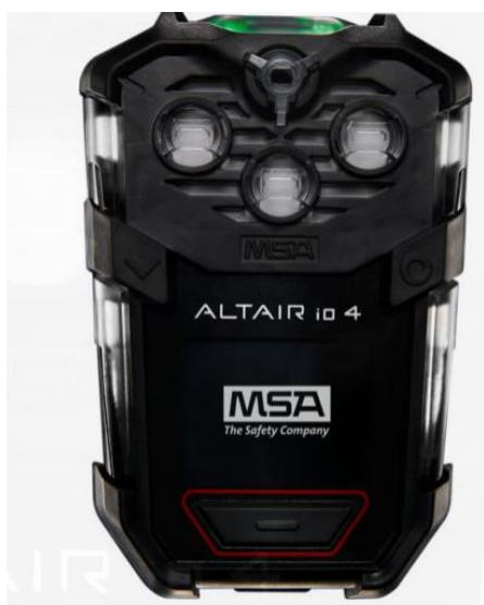
Figura 2 - Detetor multigás portátil MSA Altair io 4
