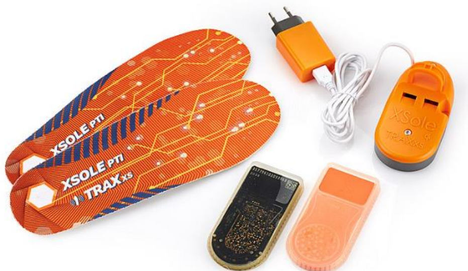
Figura 1 - Exemplo de palmilhas de segurança com sensores integrados
