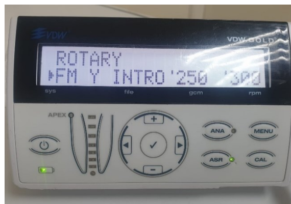
Figura 13 | Motor endodôntico Silver® Reciproc® (VDW®, Munique, Alemanha) a 300 rpm e com 250 g/cm de torque
