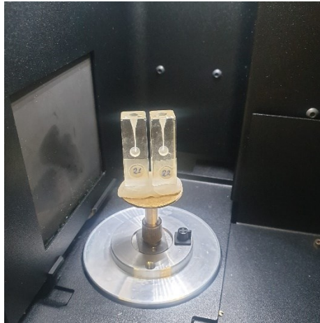
Figura 9 | Blocos n.º 21 e n.º 22 fixados ao suporte do Skyscan® 1174 (Bruker™, Kontich, Bélgica) com cera ortodôntica ORMCO®
