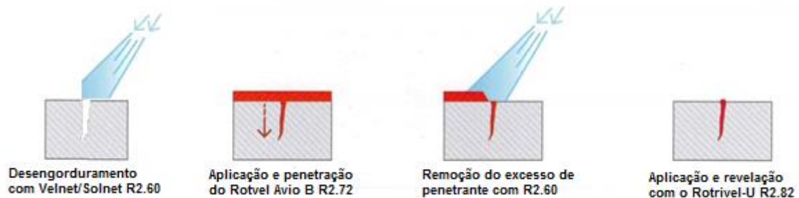
Figura 83 - Instruções aplicação líquidos penetrantes (END, 2021).
