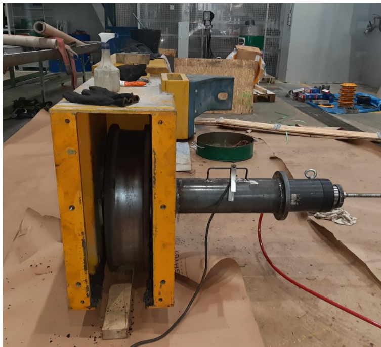
Figura 58 - Remoção das rodas do carro da ponte rolante.
