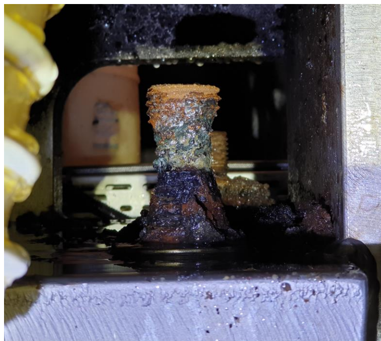
Figura 67 - Parafuso da Speedsizer solto.
