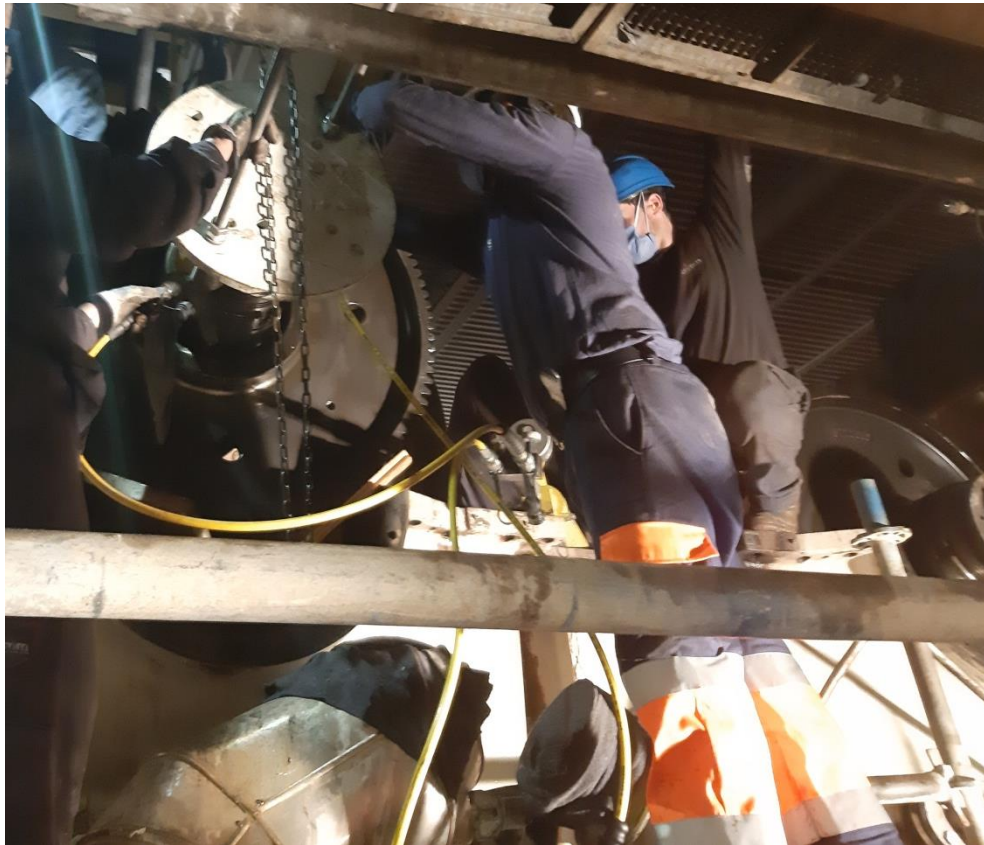
Figura 49 - Remoção da roda dentada do cilindro nº 33.
