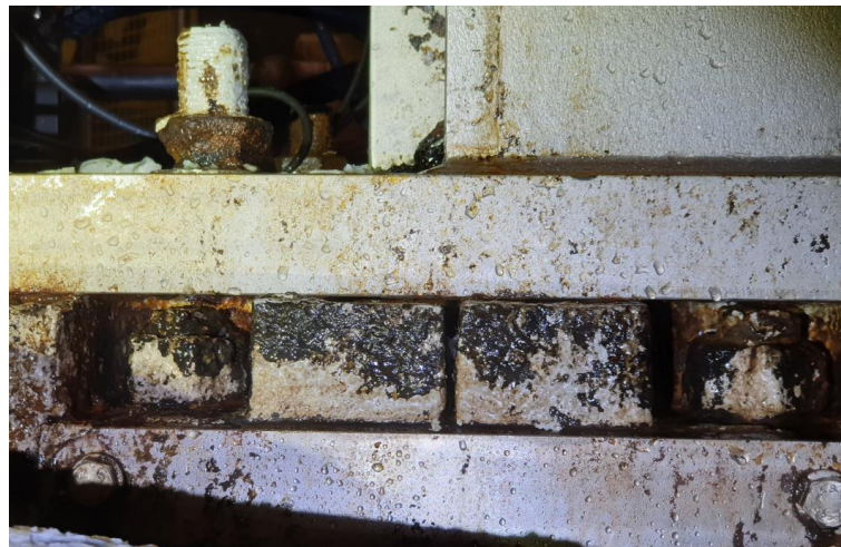
Figura 66 - Estado dos parafusos da Speedsizer.
