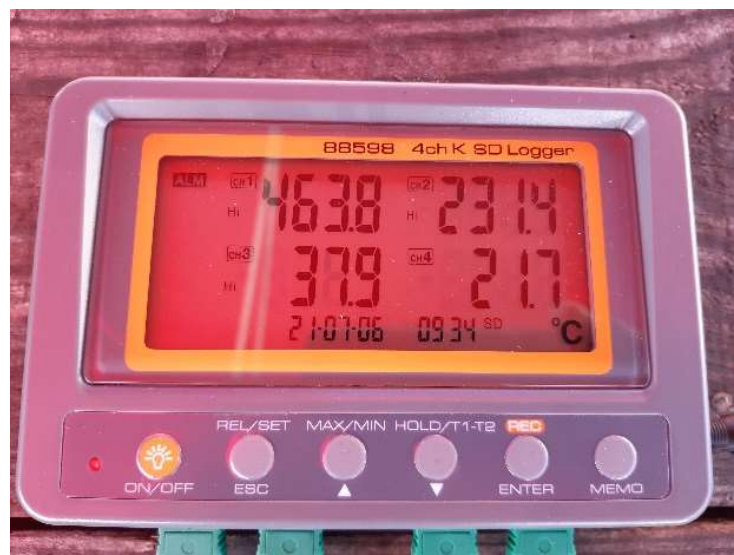
Figura 10 - Medidor de temperaturas
