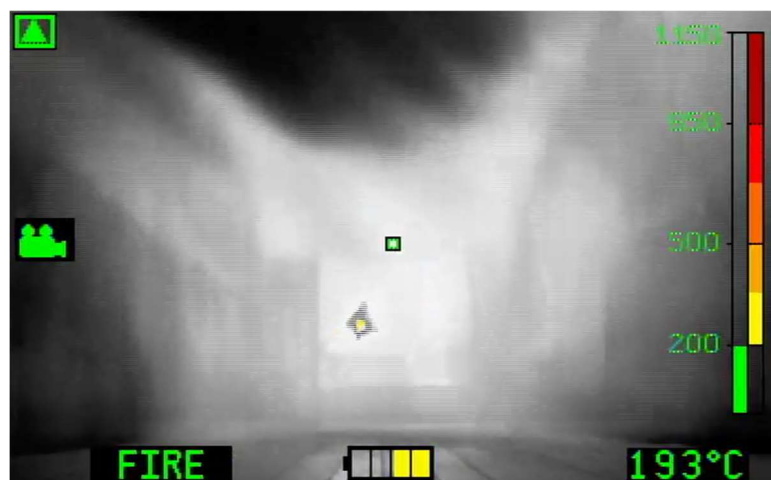
Figura 36- Imagem térmica de aplicação de água e reação do foco de incêndio
