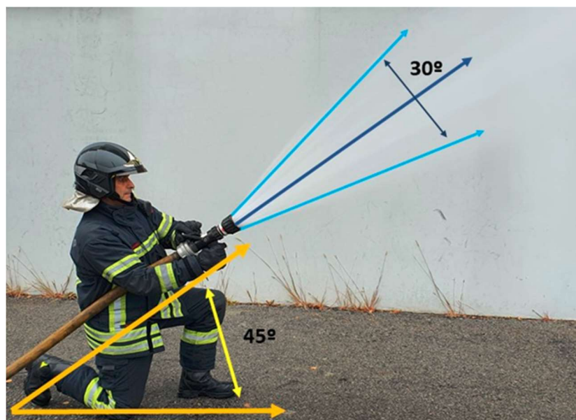
Figura 33- Ângulo de aplicação e abertura de cone para ataque indireto
