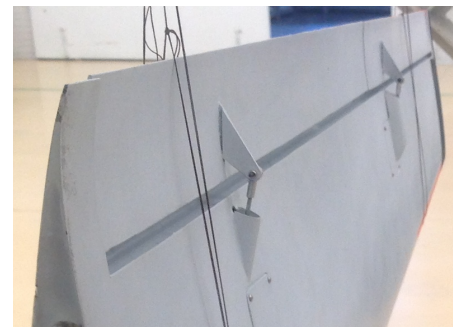
Figura 30 - Superfícies móveis de difícil modelação
