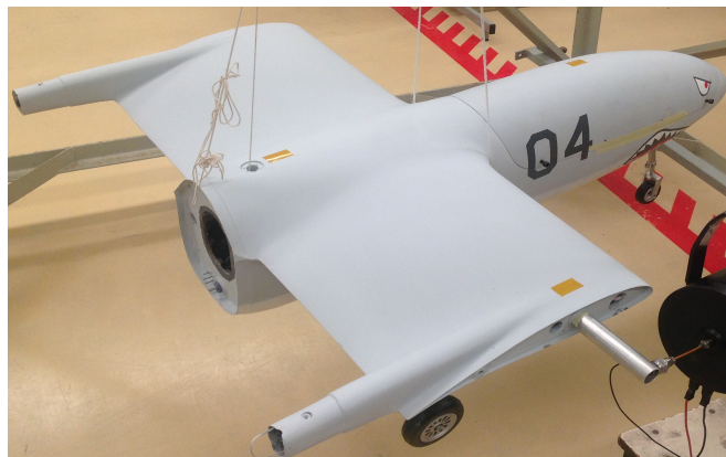
Figura 39 – Complexidade geométrica nos fusos de ligação à asa
