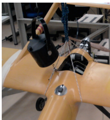
Figura 53 – Ligação do vibrador ao Alpha-Extended com motor e aviónicos
