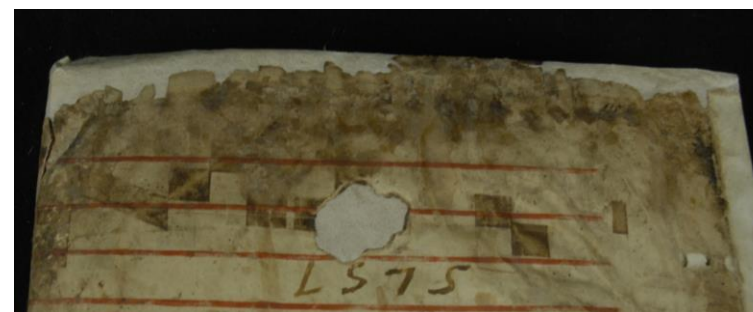
Fig. X46 - Registro fotográfico da capa do livro de notas 019 pós-intervenção. Fotografia representativa do resultado da consolidação de rasgões com tissue de 3.5 g/m 2 e preenchimento de lacunas com tissue de 13 g/m 2 .
