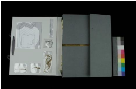
Fig. 54– Representação da união da caixa e cartão retangular a partir da passagem da fita de nastro pelos orifícios realizados em ambos os elementos.
