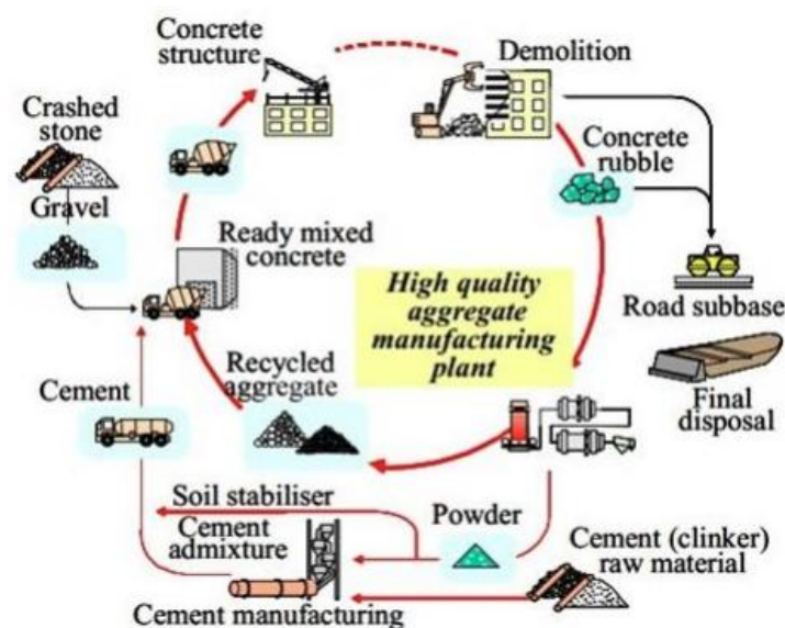
Figura 45 Processo de reciclagem de resíduos de betão [84].
