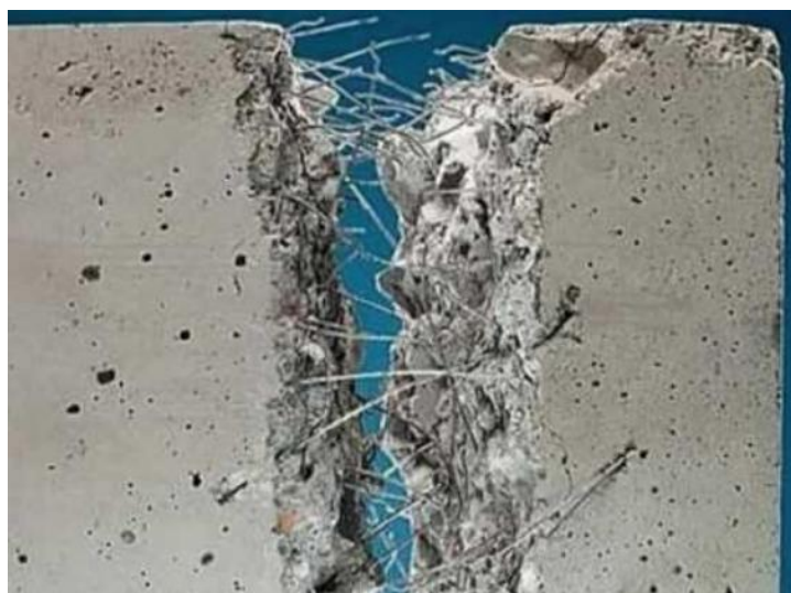
Figura 25 Aspeto de betão reforçado com fibras [53].
