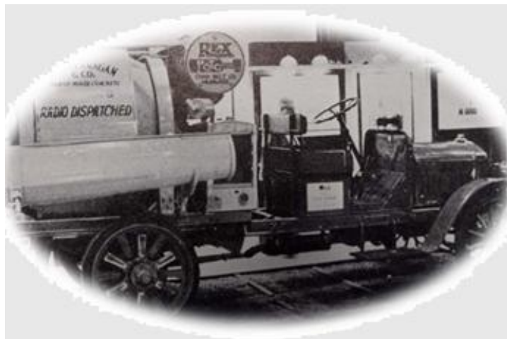
Figura 32 Misturadora horizontal Rex Chain Belt de 1922 com capacidade para 1 m 3 , montado num camião G.M.C. [64].
