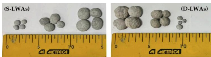
Figura 21 Agregados artificiais leves simples (S-LWAs) e agregados artificiais leves duplos (D-LWAs) [49].
