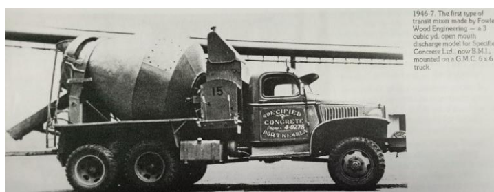
Figura 38 Primeira betoneira fabricada pela Fowler Wood Engineering, uma betoneira de 3 m 3 (1946-7) [64].
