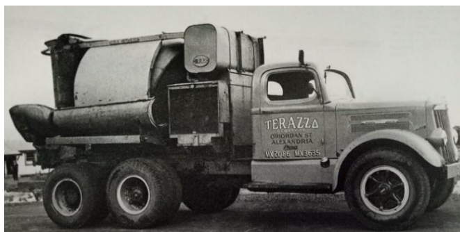
Figura 36 Betoneira Rex Motomixer. Nota: Tentativa de camuflar o tambor inclinado [64].
