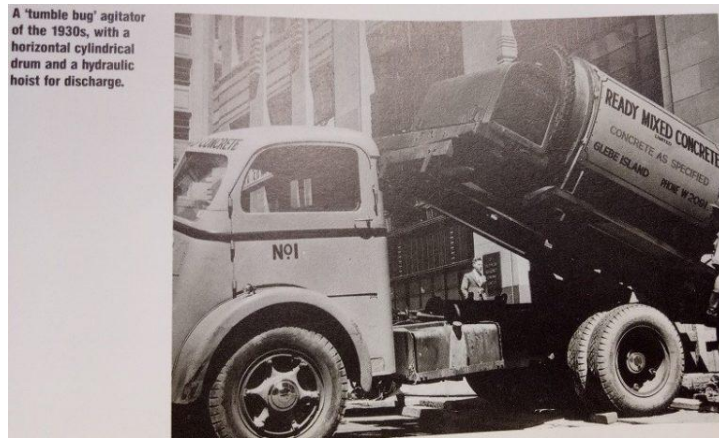
Figura 34 Agitador do tipo “tumble bug”, datado da década de 1930, equipado com um tambor cilíndrico horizontal e um mecanismo hidráulico de elevação para a descarga do betão. [64].
