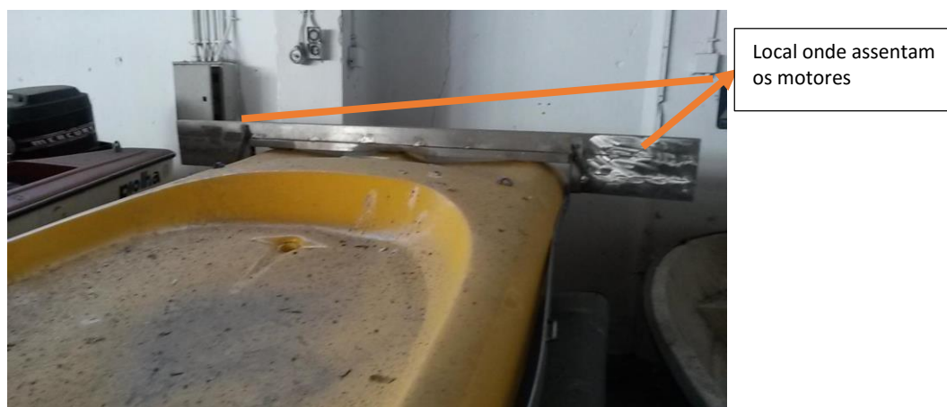
Figura 40 - Configuração do catamarã para suportar um motor elétrico em cada bordo
