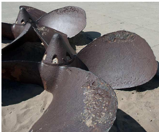
Figura 26 - Consequências da cavitação, “ pitting ” e erosão do hélice. 27
