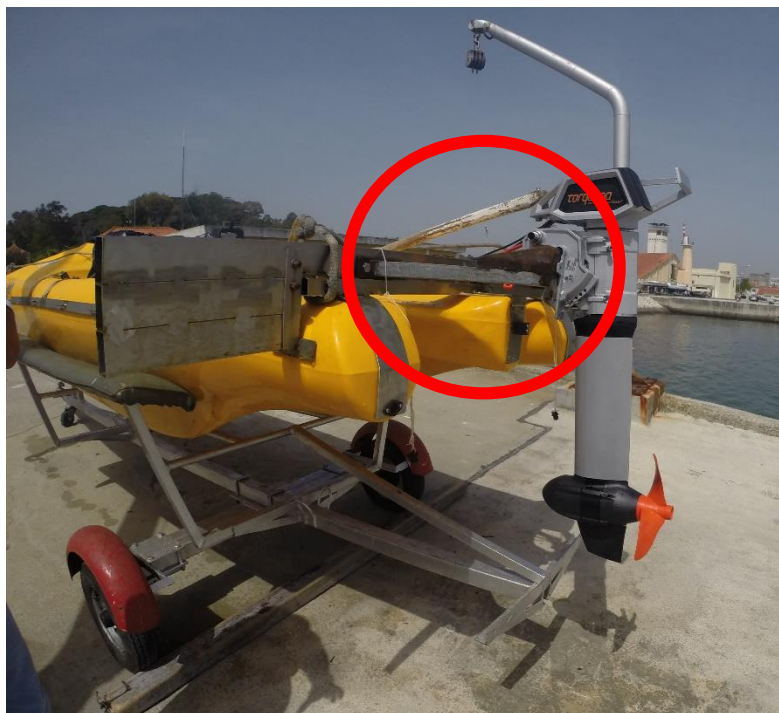
Figura 41 - Adaptação da embarcação para levar apenas um motor elétrico
