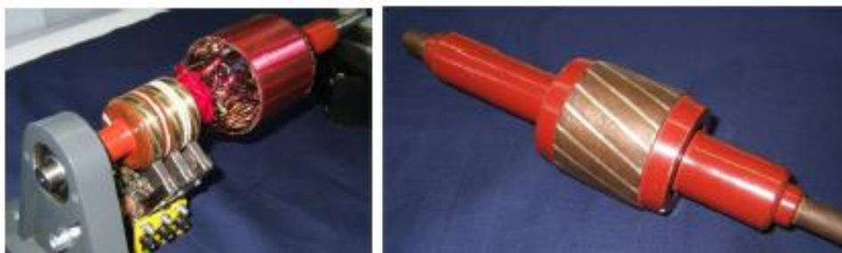
Figura 35 - Rotor bobinado à esquerda e em gaiola de esquilo à direita 36
