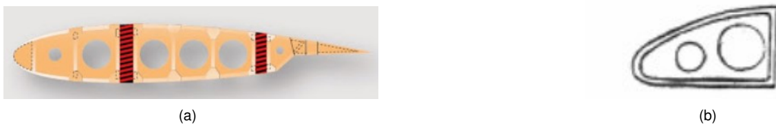
Figura 2.4: Configurações de nervuras: (a) verdadeira, Aircraft Systems Tech (2021); (b) falsa, Fernandes (2008).
