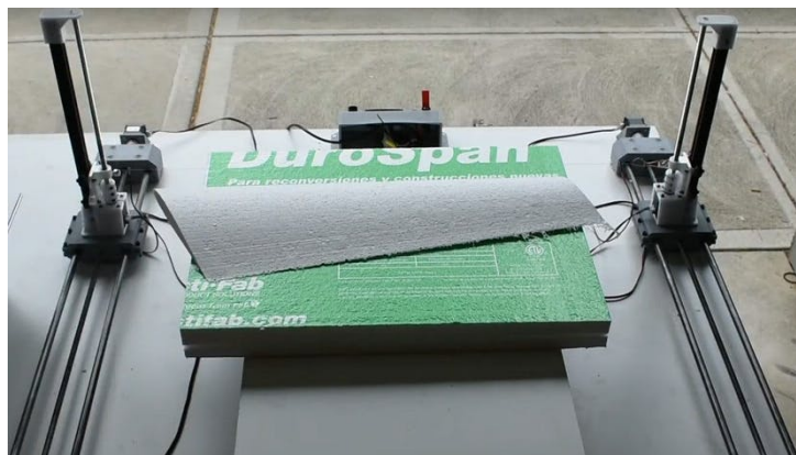
Figura 2.10: Moldagem do núcleo com recurso a uma máquina de CNC, Cook (2019).
