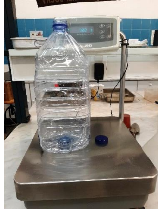
Pesagem da quantidade de água a adicionar
