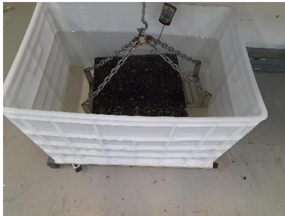
Figura 5.5. Laje imersa em água para determinação da massa volúmica (SSS)
