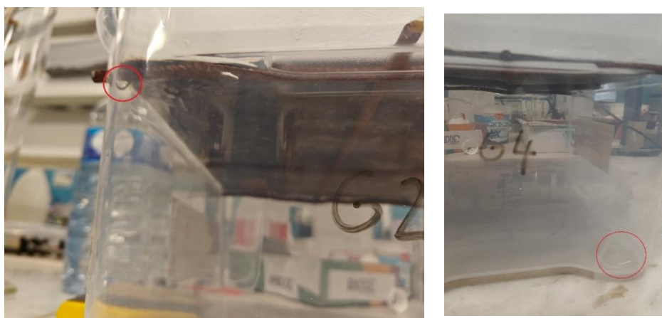
Figura 5.10. Escoamento da água pelos cantos da laje de pavimento
