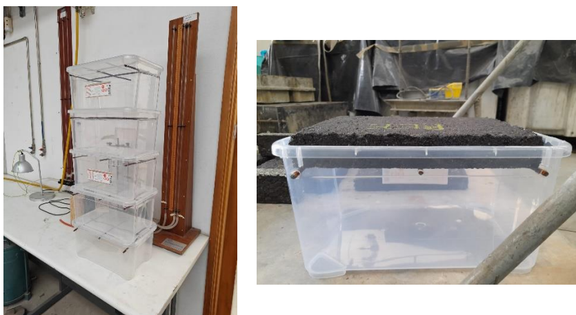
Figura 5.4. Caixas para suportar as lajes de pavimento
