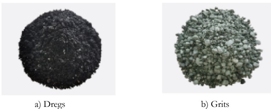
Figura 3.10. Resíduos da recuperação química (Altri, 2021)
