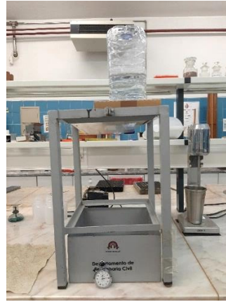
Monitorização do tempo necessário para o escoamento do caudal pretendido
