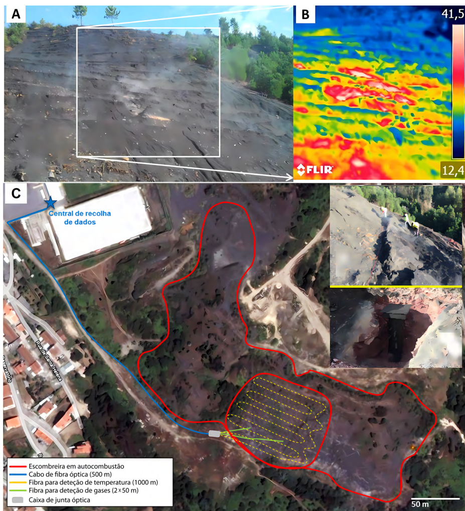
Figure 15 – (A) Perspetiva da área em combustão na escombreira, onde é possível observar a estrutura em socacos ao longo do declive, assim como as emissões gasosas; (B) Imagem termográfica utilizada para caracterizar preliminarmente a temperatura nesta zona; (C) Vista aérea da escombreira de São Pedro da Cova (contorno a vermelho), onde é possível identificar: (i) a região onde foi efetuada a medição distribuída da temperatura com um cabo de sensor óptico com de cerca de 1300 m de extensão (linha pontilhada a amarelo); (ii) pontos de medição das emissões gasosas (extremidades das linhas a verde); e (iii) o trajeto do cabo de fibra óptica até ao local de fotodeteção e processamento (linha azul) (adaptado de Ribeiro et al. 2017).
