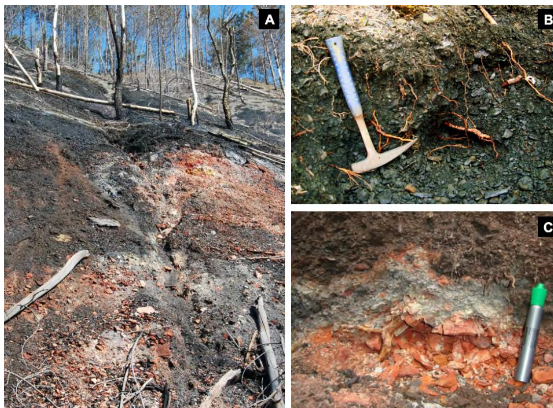
Figura 5 – (A) Aspeto geral da área queimada na escombreira de São Pedro da Cova; (B) Pormenor do material não queimado; (C) Queimado.
