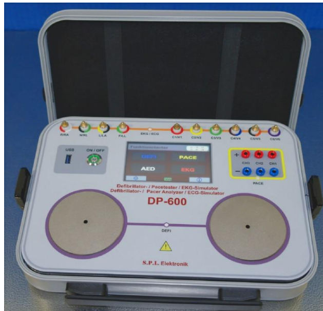
Figura 39 - DP600: Simulador de Desfibriladores [70].
