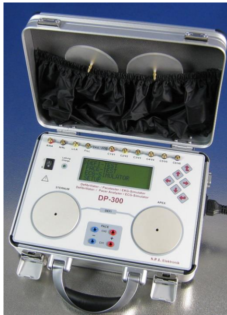
Figura 38 - DP300: Analisador de Desfibriladores [69].
