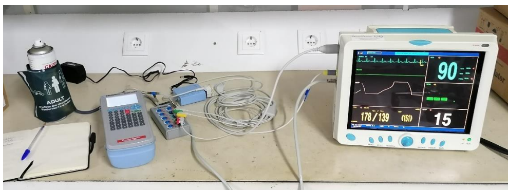
Figura 43 - Utilização do equipamento de teste Rigel UNI-SiM.
