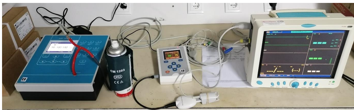
Figura 44 - Utilização dos equipamentos de teste MS100 para simulação do SpO 2 e MS200 para simulação da PANI.
