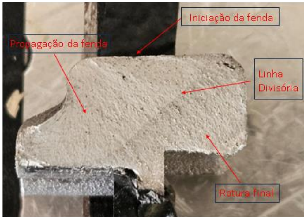
Figura 5.4 - Processo de degradação por fadiga da pedaleira de AlSi10Mg
