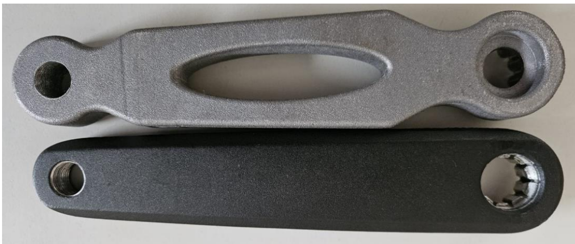
Figura 5.3 – Pedaleiras de AlSi10Mg e 6061-T6
