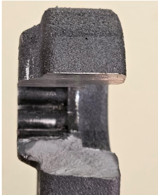
Figura 5.2 - Pedaleira produzida por L-PBF fraturada
