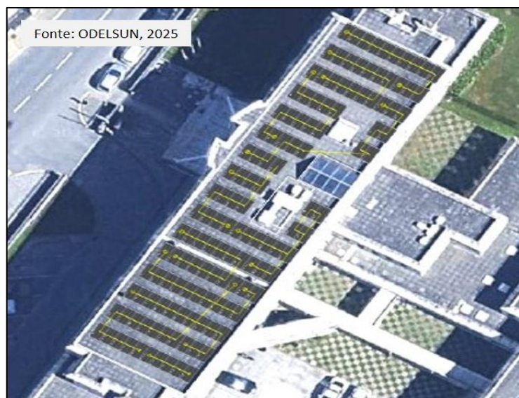
Figura 1 – Localização e disposição dos módulos fotovoltaicos
