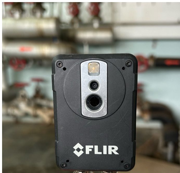
Figura 94 - Câmara termográfica FLIR AX8.
