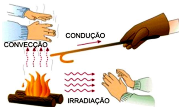
Figura 32 - Exemplos dos mecanismos de transferência de calor [43].
