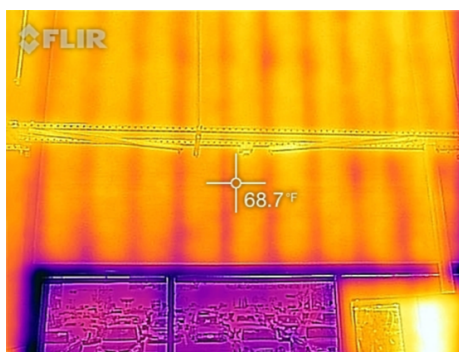
Figura 53 - A deteção de detalhes sutis, como os montantes de uma parede, requer uma alta sensibilidade térmica [53].
