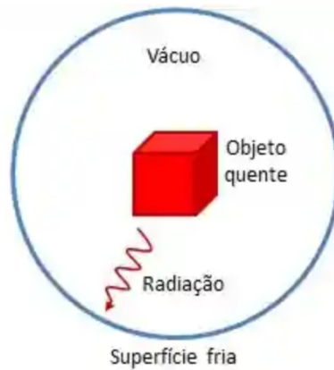
Figura 40 - Transferência de calor por radiação [42].
