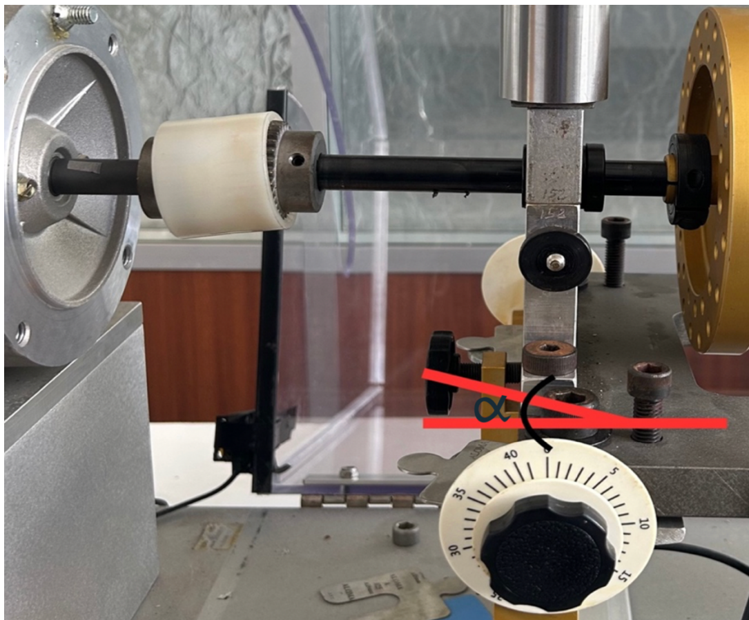
Figura 81 - Representação do desalinhamento angular no sentido horário.
