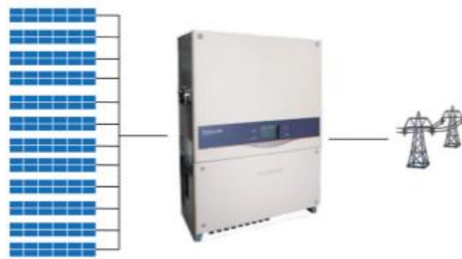
Figura 3.35-Inversor com apenas um MPPT (Canal Solar, 2019)
