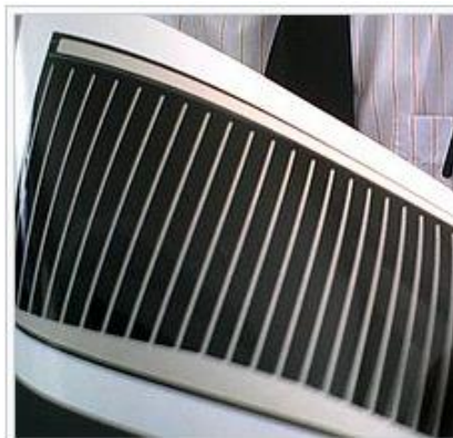
Figura 3.11- a) Célula CIGS e b) Célula de CIS (Eldin, Refaey, & Farghly, 2015)
