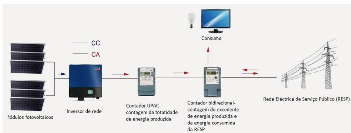
Figura 3.3 - Esquema de ligação à rede de uma UPAC (Técnica Viçosa_Energia Solar, 2015)
