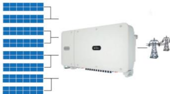
Figura 3.37-Inversor com quatro entradas de MPPT (Canal Solar, 2019)
