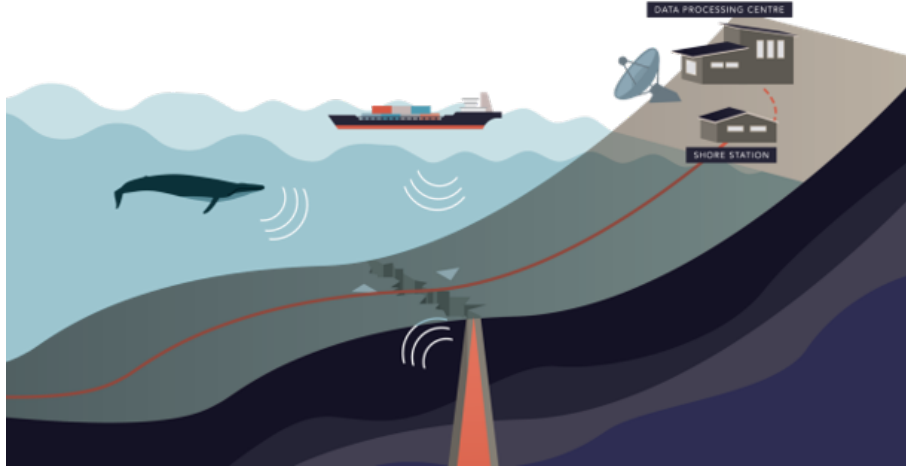
FIGURA 2.6: Esquema de uma aplicação do sistema DAS. Fonte: Adaptado de Sensing, 2023.
