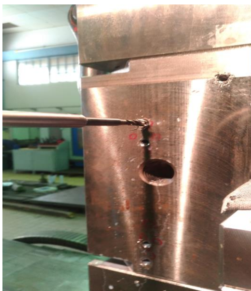
Figura 4.8. Correção do Calço efetuada na mandriladora. (GECO, 2018)
