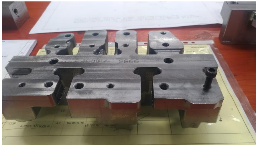
Figura 4.18. Verificação da montagem com auxílio de parafusos de rosca métrica. (GECO, 2018)
