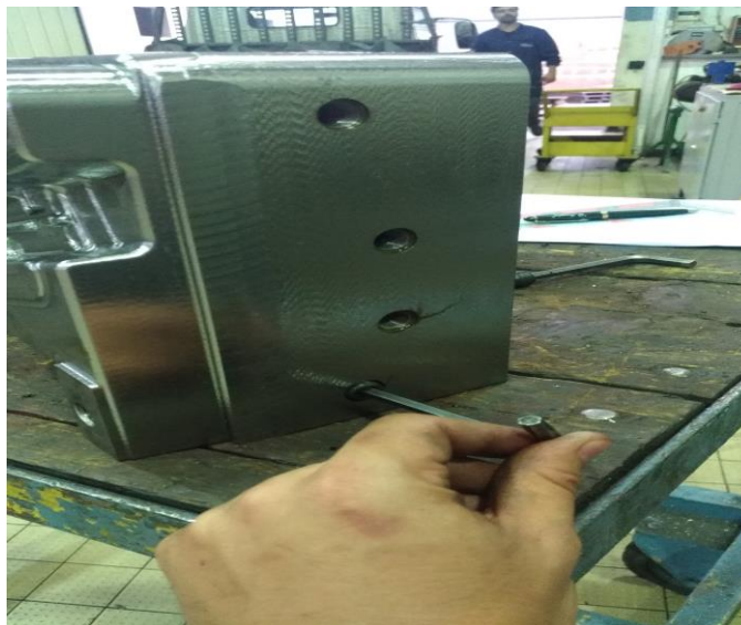
Figura 4.16. Aplicação de um tampão de 1/4" BSPT para testar a rosca. (GECO, 2018)
