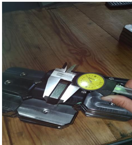
Figura 4.13. Medição da espessura da barra com auxílio de um paquímetro. (GECO, 2018)
