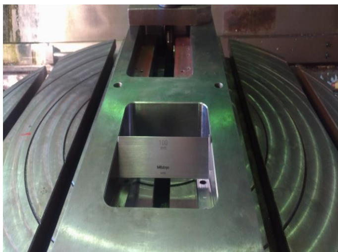
Figura 4.4. Análise das paredes pela utilização de calibres. (GECO, 2018)
