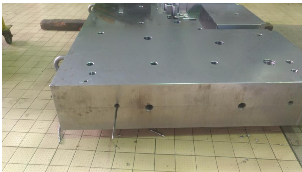
Figura 4.12. Análise do circuito com auxílio de uma vareta. (GECO, 2018)
