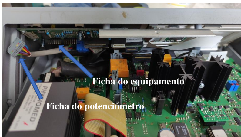
Figura 69 – Desencaixe da ficha do potenciómetro
