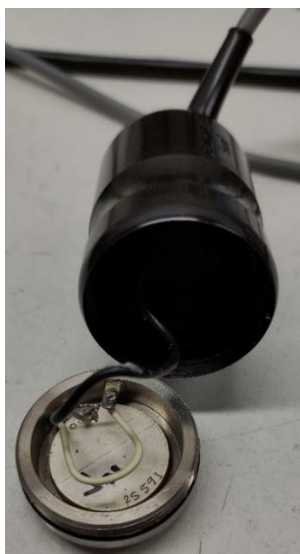
Figura 64 – Interior do transdutor de ultrassom
