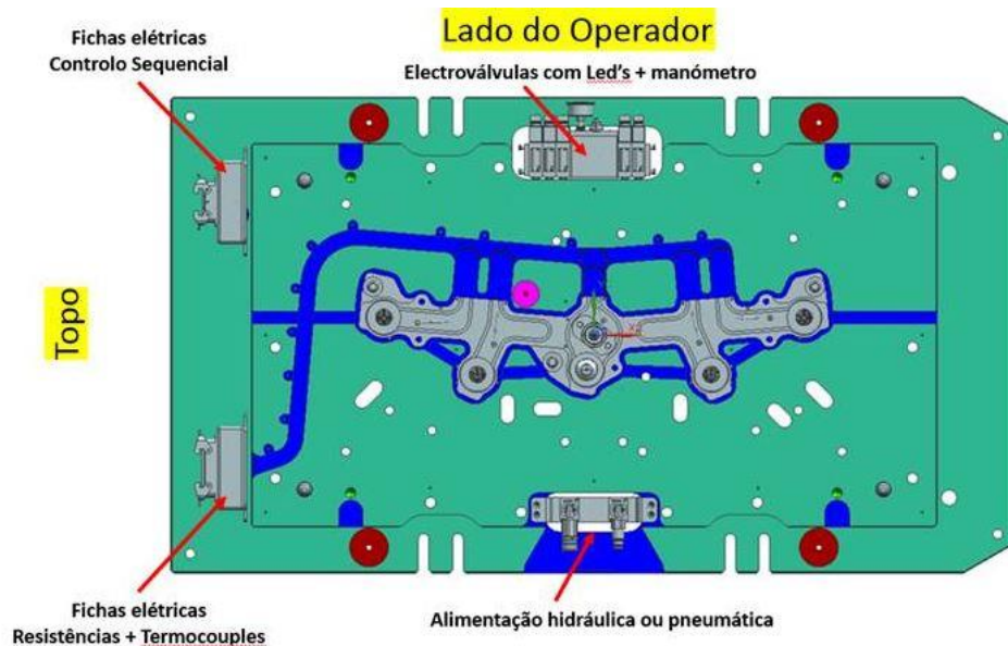
Figura 108 – Medidas e posicionamentos para a conceção dos sistemas de injeção
