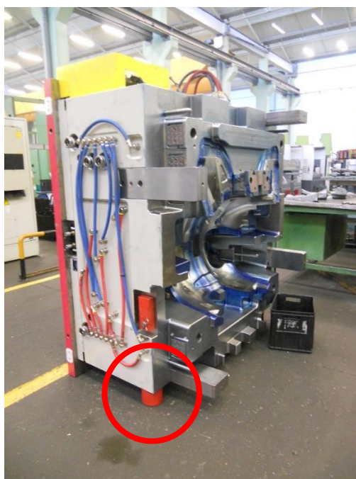
Figura 56 – Cavidade de um molde apoiada pela placa de encosto e pelos pés (IGM, 2018)
