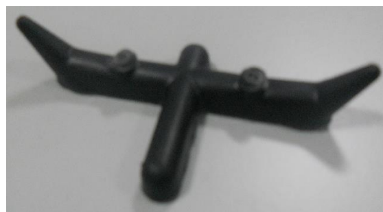
Figura 24 – Jito originado de um ataque submarino (DT IGM, 2018)
