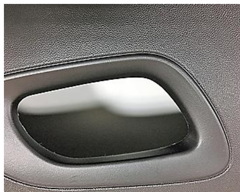
Figura 68 – Detalhe da textura na zona do puxador do painel de porta (DT IGM, 2018)
