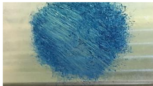
Figura 178 – Zarcão (azul) usado no aço para acertar ajustes
