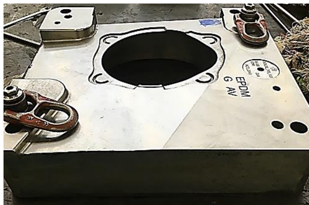
Figura 55 – Bloco de aço com olhais de transporte e manuseamento (IGM, 2018)
