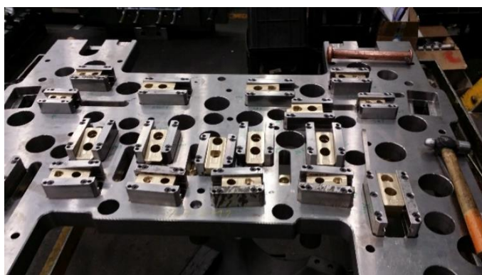
Figura 173 – Montagem de acessórios numa placa de extração
