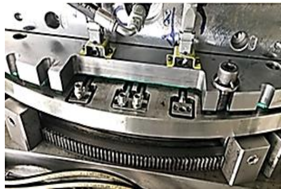
Figura 13 – Fixação do molde por parafusos, em ensaio (Simoldes Plásticos, 2018)
