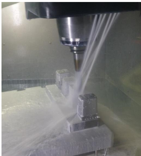
Figura 169 – Maquinagem de postiços
