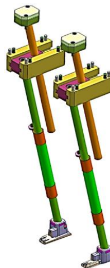
Figura 50 – movimentos à extração com veio de reforço (DT IGM, 2018)
