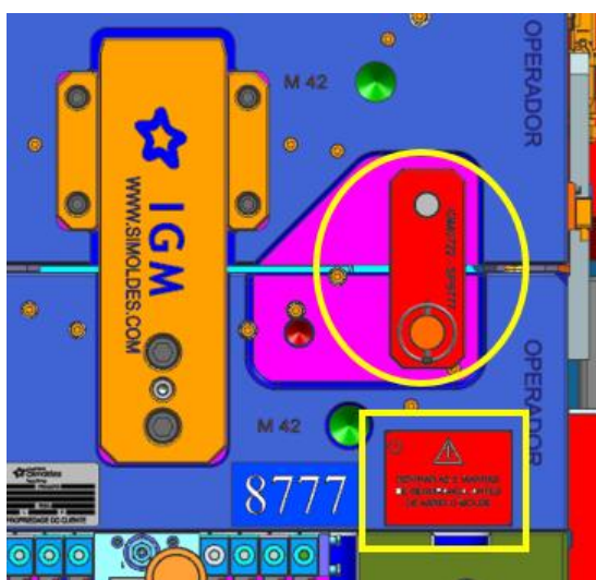
Figura 54 – Barra de segurança (O) e chapa de alerta (□) de uma segunda barra no lado oposto (DT IGM, 2018)
