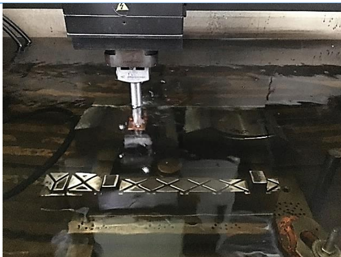
Figura 166 – Eletroerosão nos movimentos à extração em processamento
