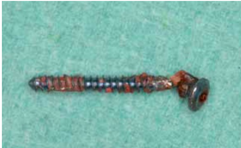
Figura 9 – Parafuso de titânio com 1.2mm de diâmetro fraturado durante o processo da sua remoção. Imagem retirada de (Khoury & Hidajat, 2011).
