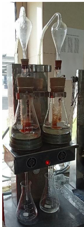
Figura 23- Determinação da acidez do rescaldo (à esquerda) e da piqueta (à direita) com o destilador de Cazenave-Ferré.
