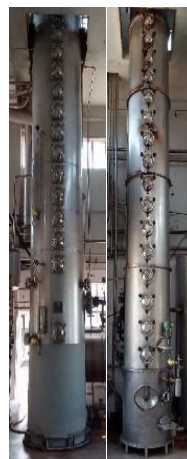
B: Coluna de destilação das piquetas (à esquerda) e das borras de vinho (à direita)
