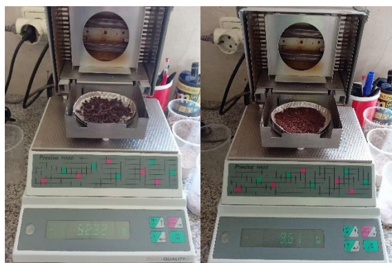
Figura 26- Determinação do teor de humidade na estufa do bagaço de uva (à esquerda) e da grainha (à direita).
