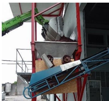
C: Transporte de bagaço para o tegião de receção
