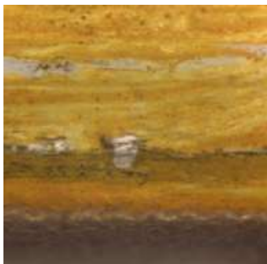
Figura 41 - Observação da espessura da camada de tinta à lupa binocular, ampliação 40 x.
