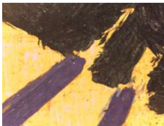
Figura 47 - Observação da sobreposição da camada de tinta à lupa binocular, ampliação 16 x.
