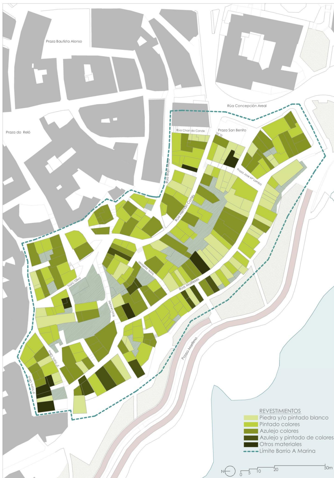
Fig. 68. Mapa de revestimientos en fachada.
