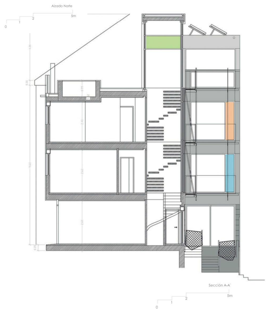
Fig. 185. Sección de estado actual.
