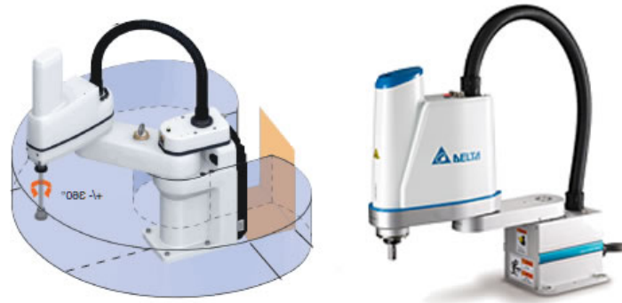
Figura 2.5: Robô do tipo SCARA e sua área de trabalho[10]
