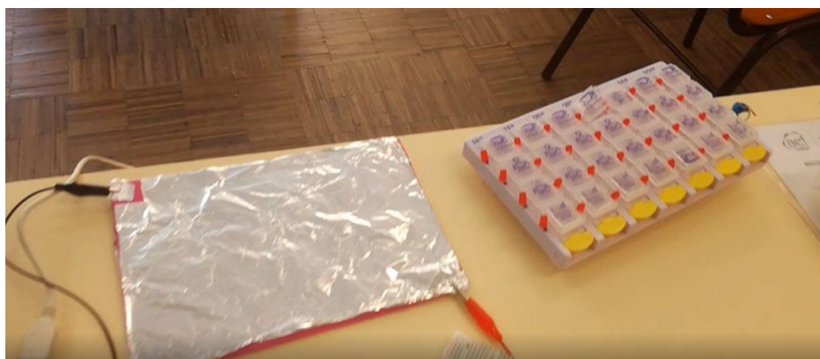
Figura 6 - Sensor de pressão com papel de alumínio e espuma "eva"
