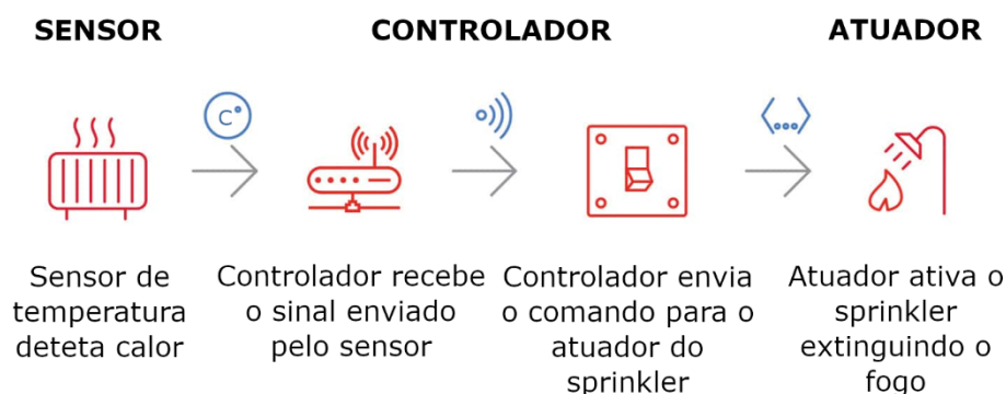
Fig. 15 – Esquema de princípio da interação entre um sensor, controlador e atuador 7
