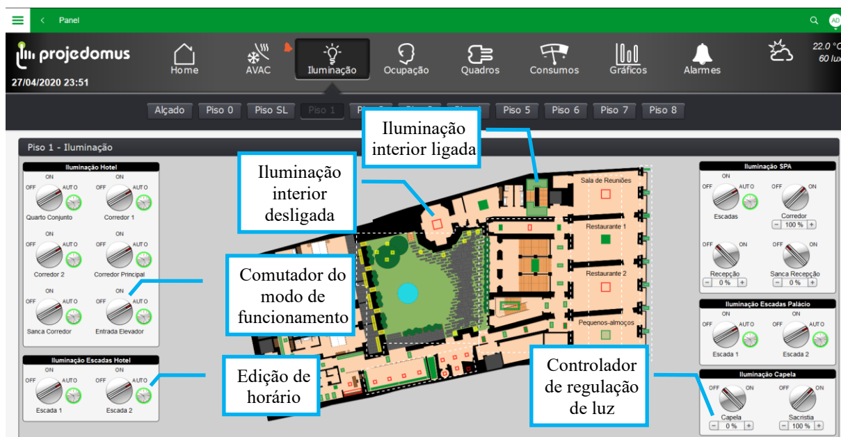
Fig. 73 – Controlo/Monitorização da iluminação
