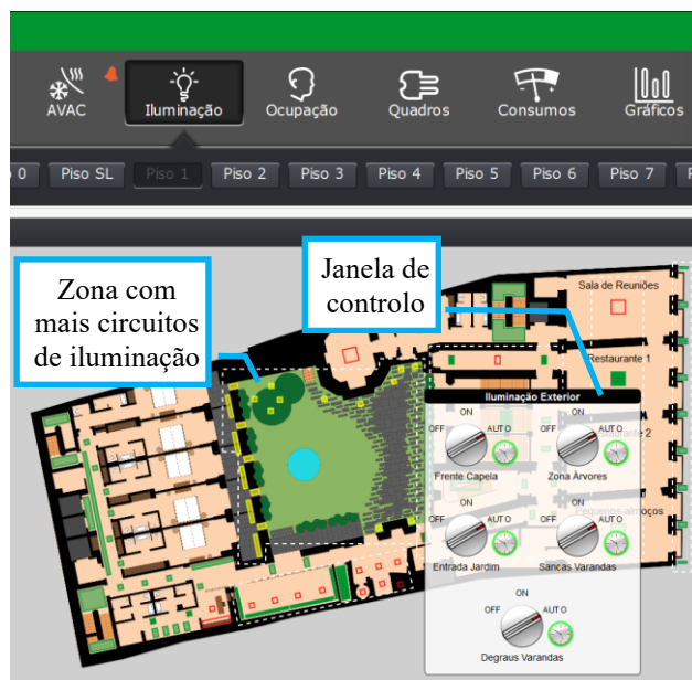
Fig. 74 – Janela com mais circuitos de iluminação para controlo
