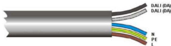
Fig. 40 – Exemplo de cabo com alimentação e BUS DALI para ligação a balastros DALI (Tridonic, 2019)
