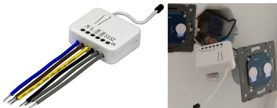
Figura 46 – Módulo Z-Wave de iluminação (à esquerda) e montagem (à direita)
