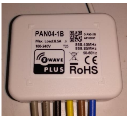
Figura 59 – Módulo de iluminação Z-Wave
