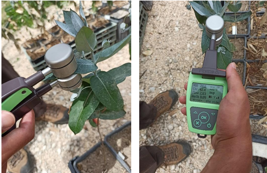
Figura 13: Metodologia utilizada em campo, com o aparelho DUALEX 4 Scientific para avaliação da clorofila e flavonoides
