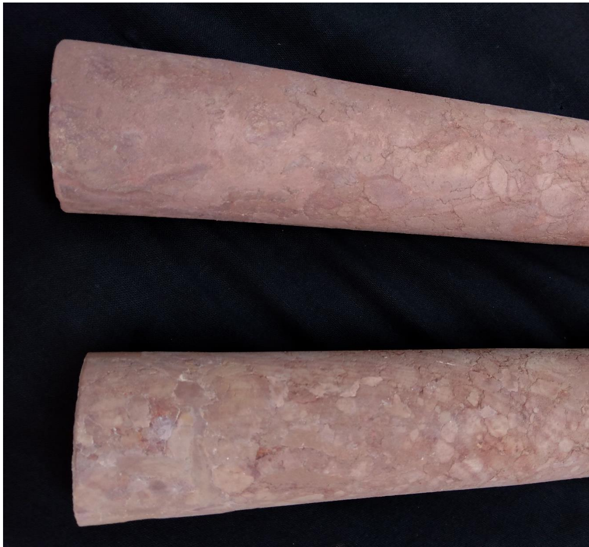
Figura 38. Reintegração cromática com pigmentos inorgânicos aglutinados em resina epoxi. Foto: autoria do aluno.
