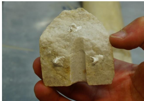
Figura 33. Aplicação de adesivo por pontos. Foto: autoria do aluno.
