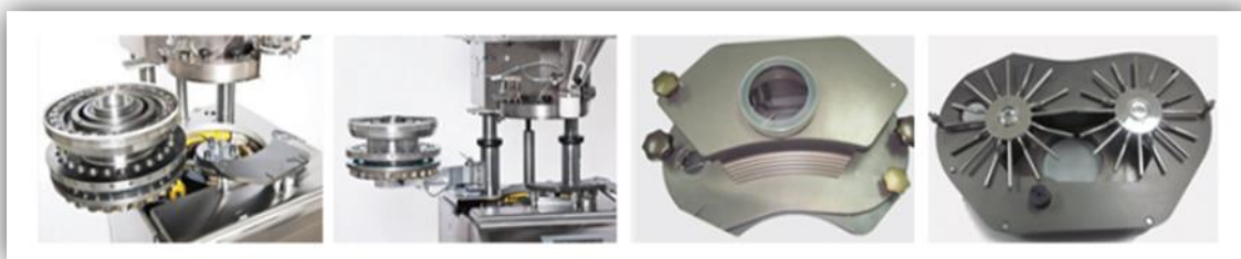
Figura 3. 15 - Cam, torre e impulsor para o sistema de alimentação da prensa para comprimidos (SaintyCo, 11 Critical Tablet Compression Machine Parts You Must Know to Optimize Tableting Process, 2020)
