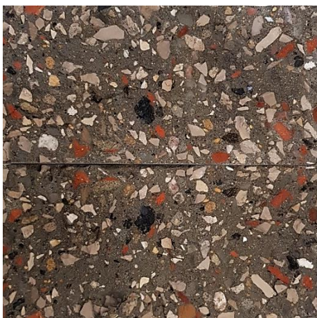
Figura 4.10 - Superfícies de rotura verificadas no ensaio de tração por compressão diametral
