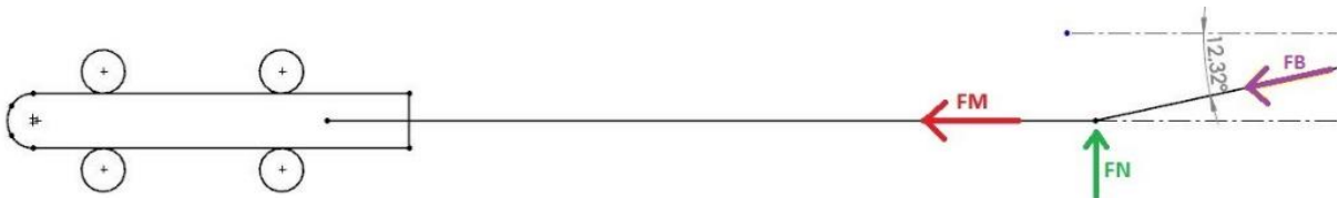
Figura 2.51 - Esquema do 2º cálculo. As setas (vermelha, verde e roxa) representam a direção e os sentidos das forças envolvidas
