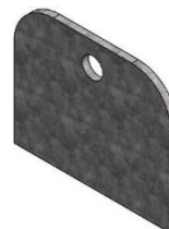
Figura 2.39 - Chapa da ligação do gancho à plataforma
