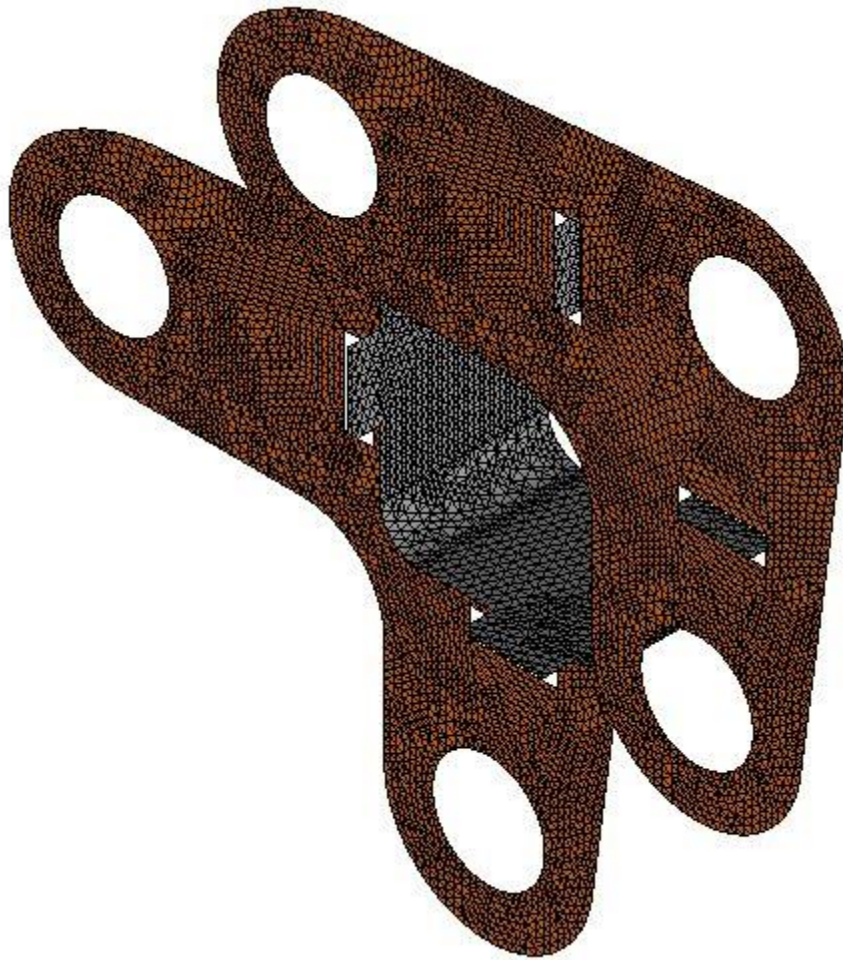
Figura A.50 - Aspeto da malha convergida
