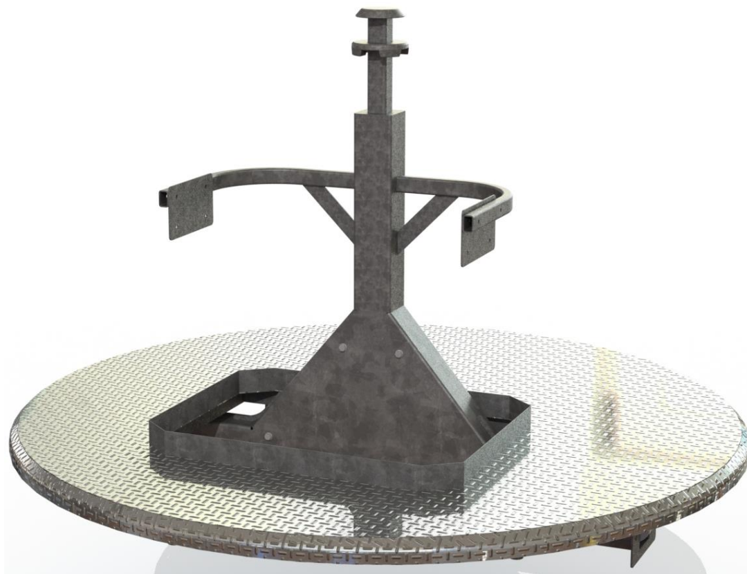
Figura A.9 - Render's do sistema de extração, com e sem aro de solo, respetivamente
