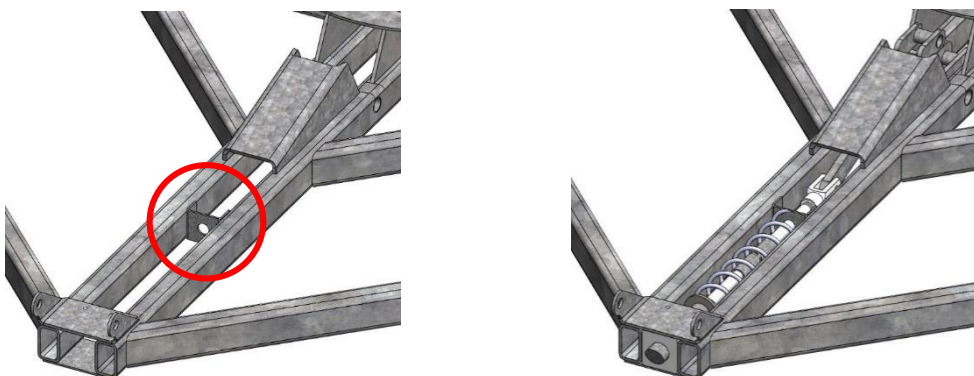
Figura 2.40 - Fixações das partes móveis da versão 1.2 do MB. Círculo vermelho – ligação da mola à plataforma
