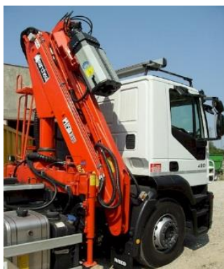
Figura 3.17 - Camião de recolha para contentores com sistema Kinshofer e o componente do sistema
