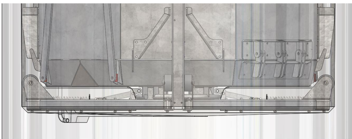
Figura 2.1 - Contentor metálico e plataforma de segurança no fundo da cuba de betão
