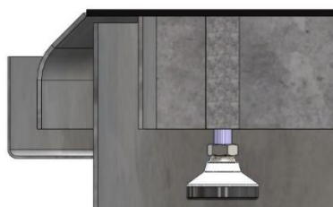
Figura 3.36 - Encaixe da plataforma de solo no aro de solo
