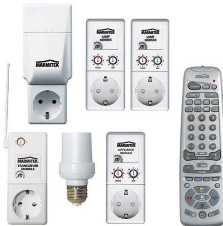
Figura 3.6 - Alguns dispositivos para sistemas X-10 [11]
