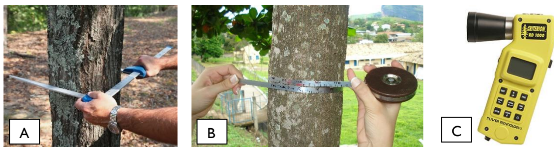
Figura 2 - Equipamento de medição de diâmetro das árvores. A-Suta, B-Fita métrica e C-Dendrómetro digital (Fonte: SoilControl, 2023).
