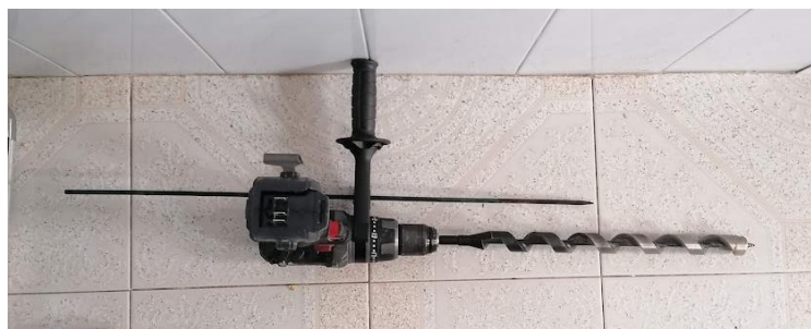
Figura 30 - Berbequim com broca helicoidal utilizado para obtenção das amostras de solo.
