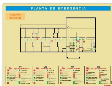
Figura 8 - Planta de emergência
