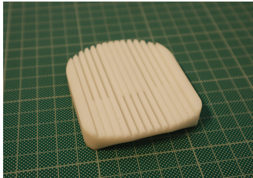
Figura 72 - Impressão 3D à escala com rasgos no encosto
