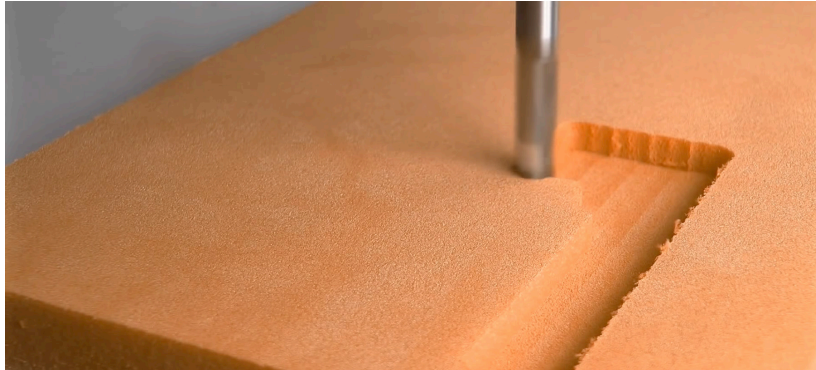
Figura 42 - Maquinação da espuma com CNC
