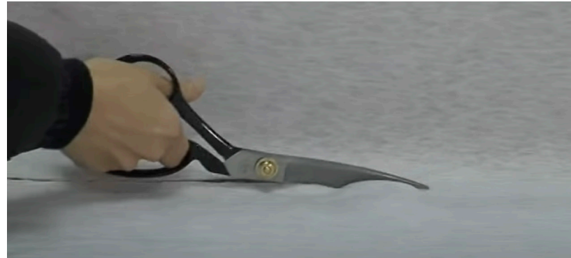
Figura 47 - Recorte das formas marcadas no tecido
