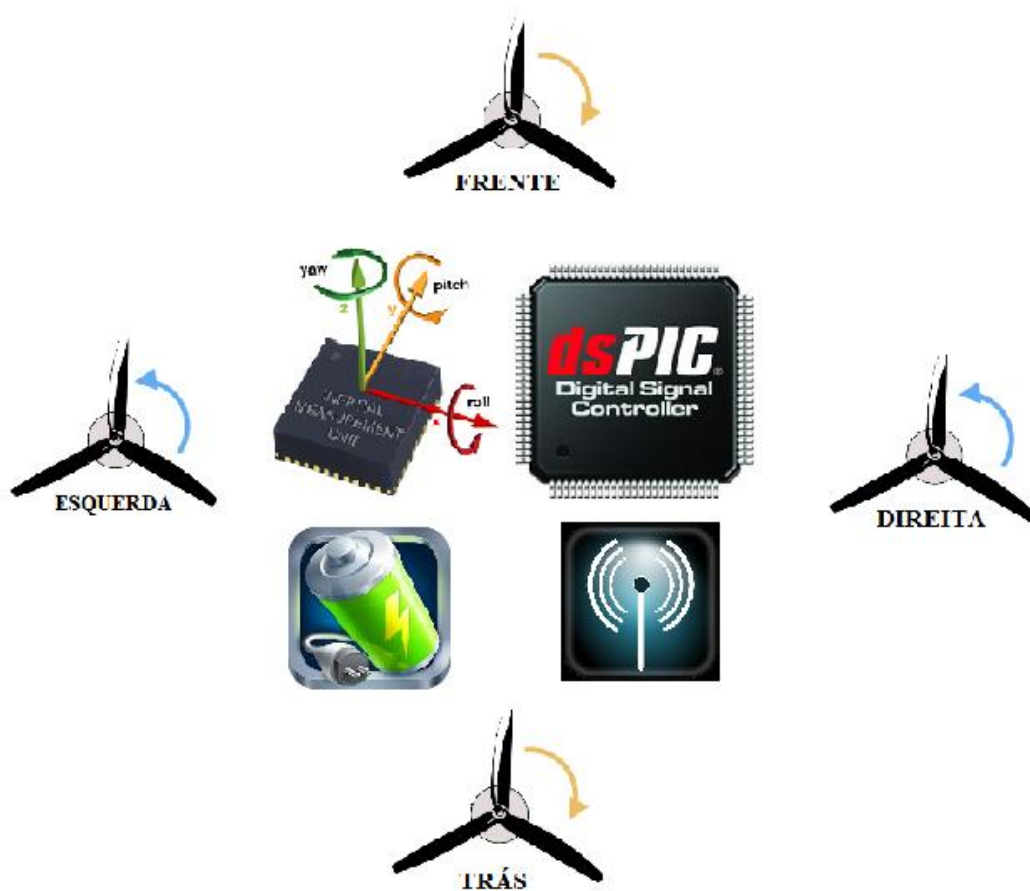
Figura 10 – Movimento de rotação no eixo do x em função da variação da velocidade angular das hélices.
