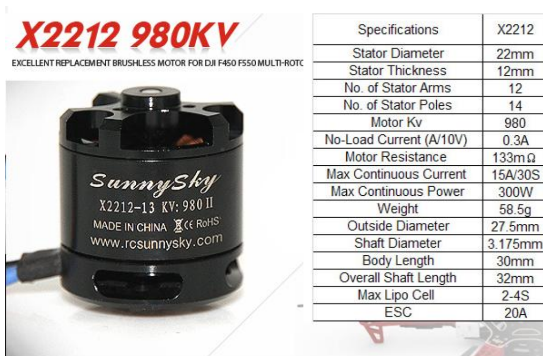
Figura 29– Motor X2212 e as características elétricas. (RCsunnysk, 2014).
