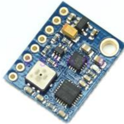
Figura 52 – Placa de sensores baseada no circuito integrado MPU-6050.
