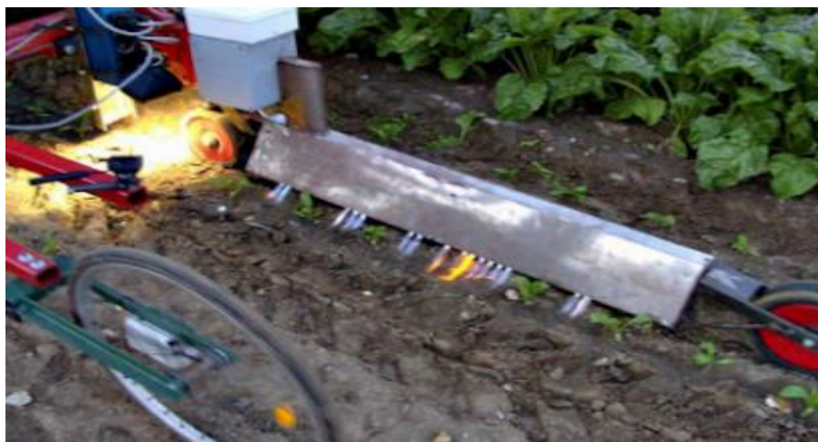
Figura 26 - Sistema térmico com possibilidade de ser usado na linha de cultura. Fonte: University of Maine School of Food and Agriculture
