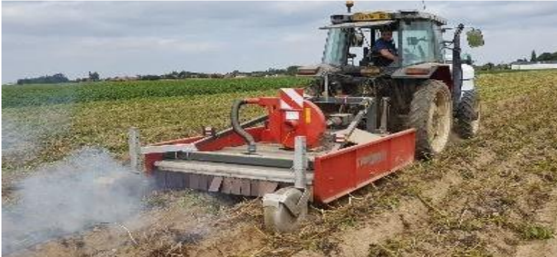
Figura 27 - Sistema térmico com ventilador e controlo eletrónico de ignição. Foto Vanhouck.
