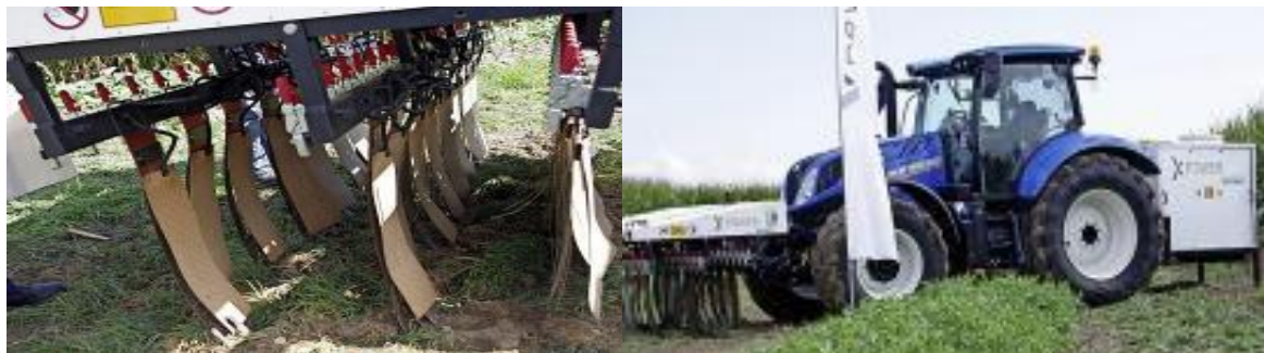
Figura 28 - Sistema de controlo com alta tensão da X-Power. Fonte: Zasso
