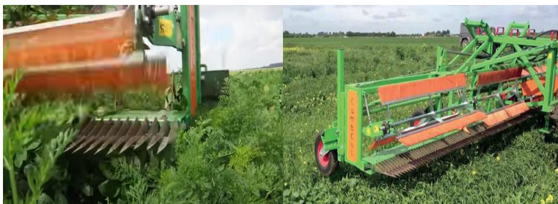
Figura 24 - Sistema mecânico que corta através de lâminas fixas. Fonte: CombCut
