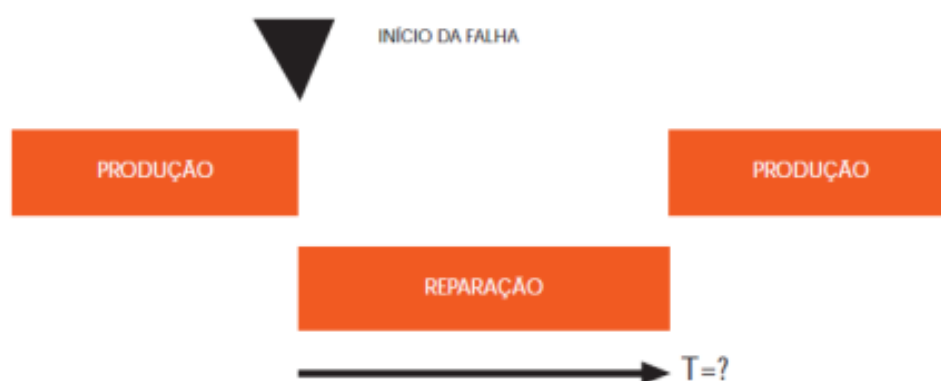
Figura 6: Representação da prática de manutenção corretiva após falha de um bem (BRITO, 2003)
