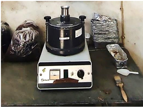
Figura 71: Moinhos de motor Retsch com crivo.
