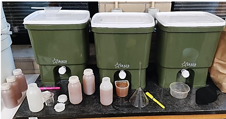
Figura 33: Disposição dos compostores Bokashi ORGANKO e recolha de lixiviado.
