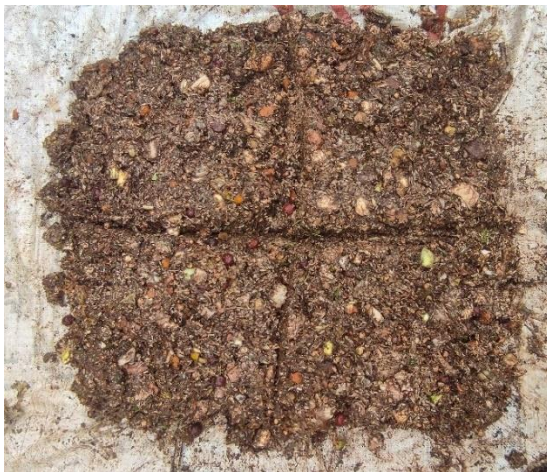
Figura 19: Mistura com a pá e início do quarteamento para seleção do volume a ser transferido para os compostores.
