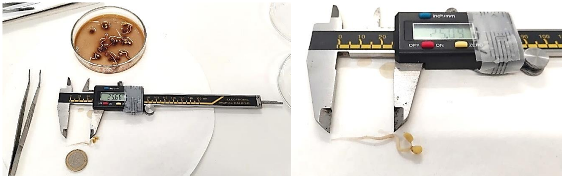
Figura 69: Registo em 18/10 - Placa com sementes germinadas e forma de medida da radícula (Paquímetro – Electronic Digital Caliper: inch/mm.)
