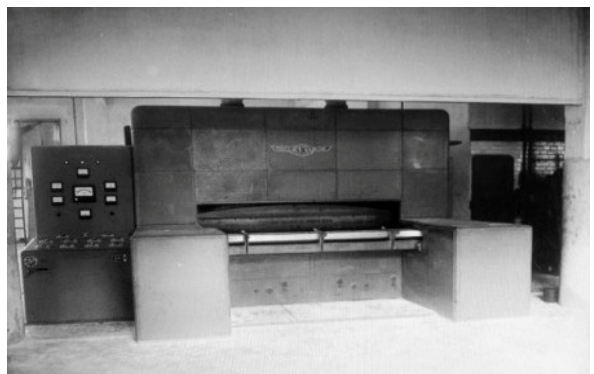
185. Horno industrial totalmente montado
