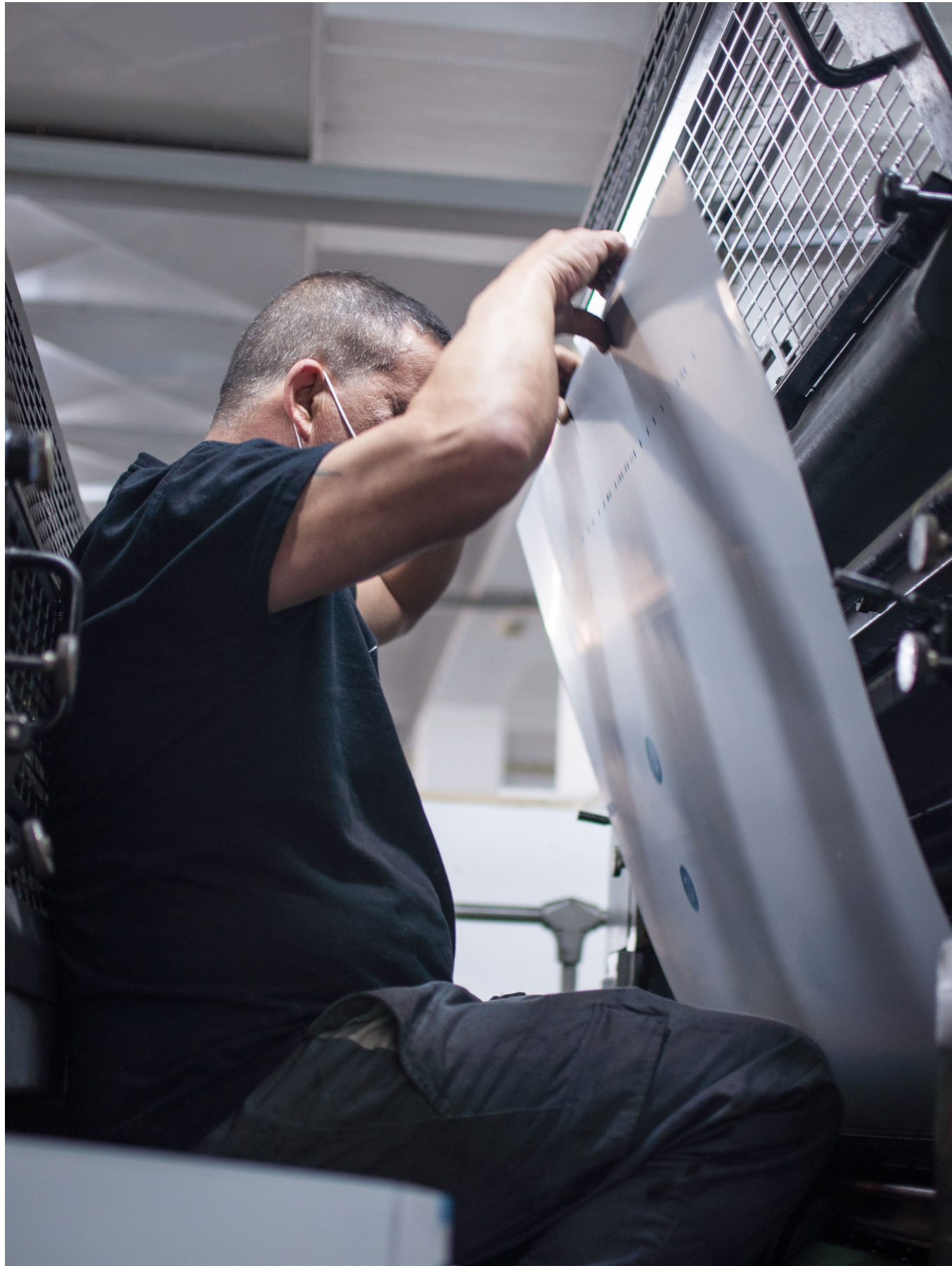
FIG.59 Colocação da chapa matriz.
