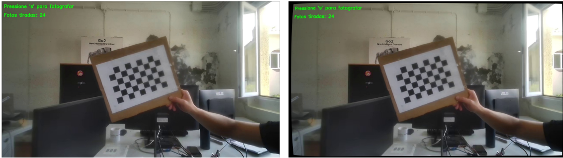
FIGURA 5.2: Comparação entre a imagem original (esquerda) e a imagem após correção da distorção (direita).
