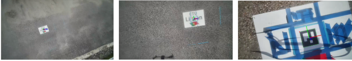
FIGURA 5.3: Detecções de marcador ArUco ID 23 de 13.2 cm.
