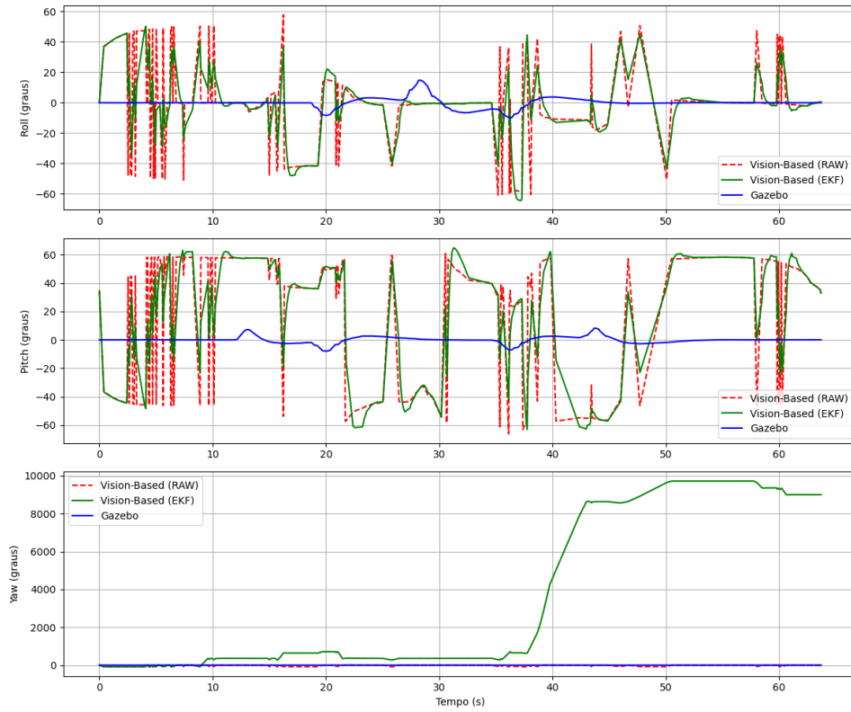
FIGURA D.8: Erro de orientação estimada (RAW vs EKF) — Trajetória em formato infinito com marcador H de 80 cm.
