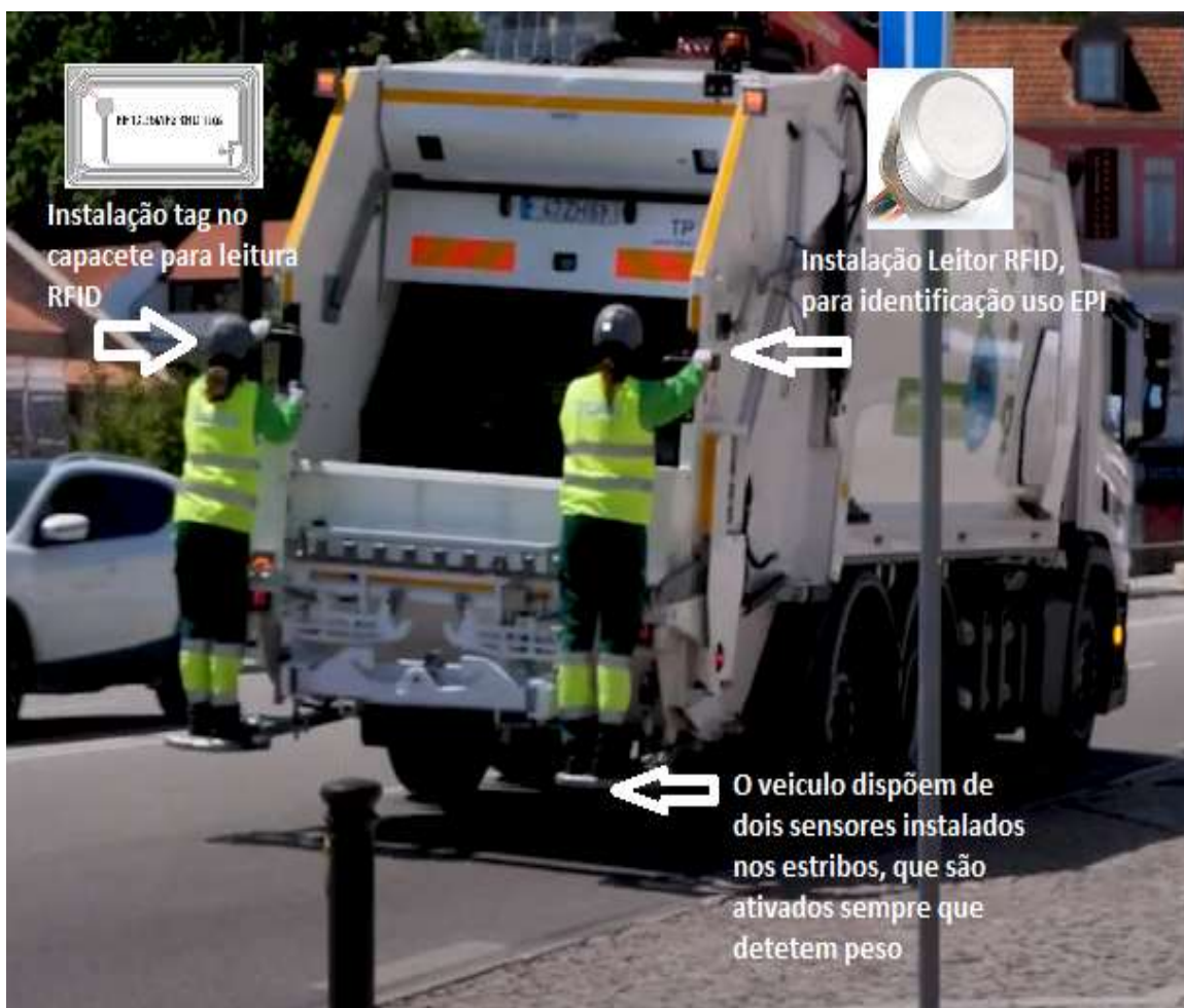
Figura 32- Instalação do sensor RFID no camião
