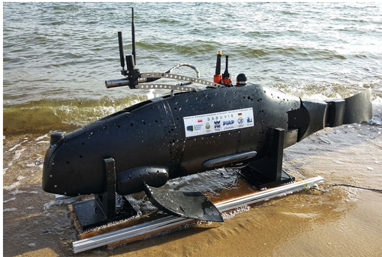
FIGURA 1.2: BUV 2 - Desenvolvido pela Universidade de Tecnologia da Cracóvia. Fonte: obtido no sítio da Naval News 3
