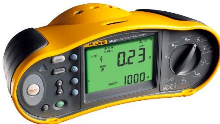
Figura anexo 0.5 - Analisador de IE (Fluke 1653B)
