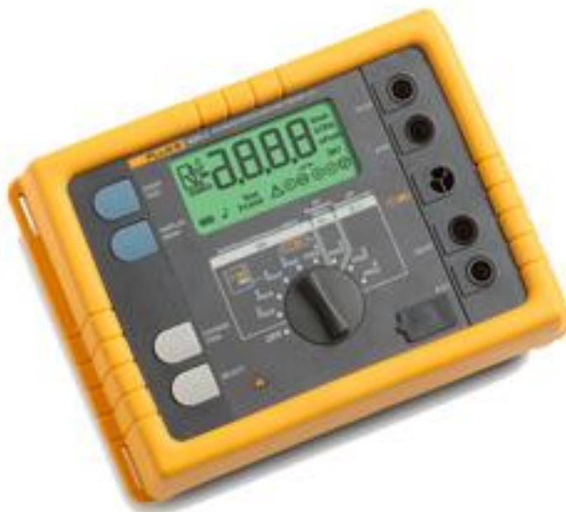
Figura anexo 0.2 - Medidor de Terras (Fluke 1625)
