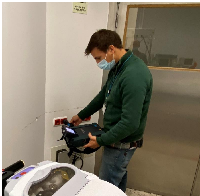
Figura 5.53 - Verificação de valores de resistência
