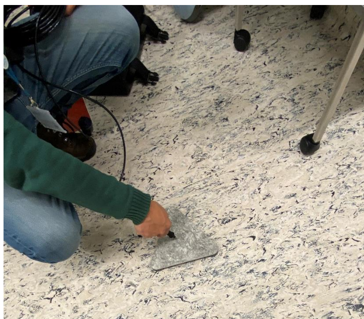
Figura 5.49 - Medição do piso condutivo
