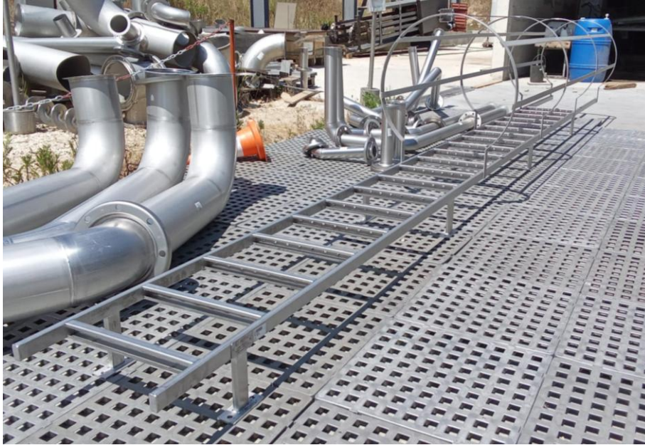
Figura 54 – Escadas após o processo de passivação
