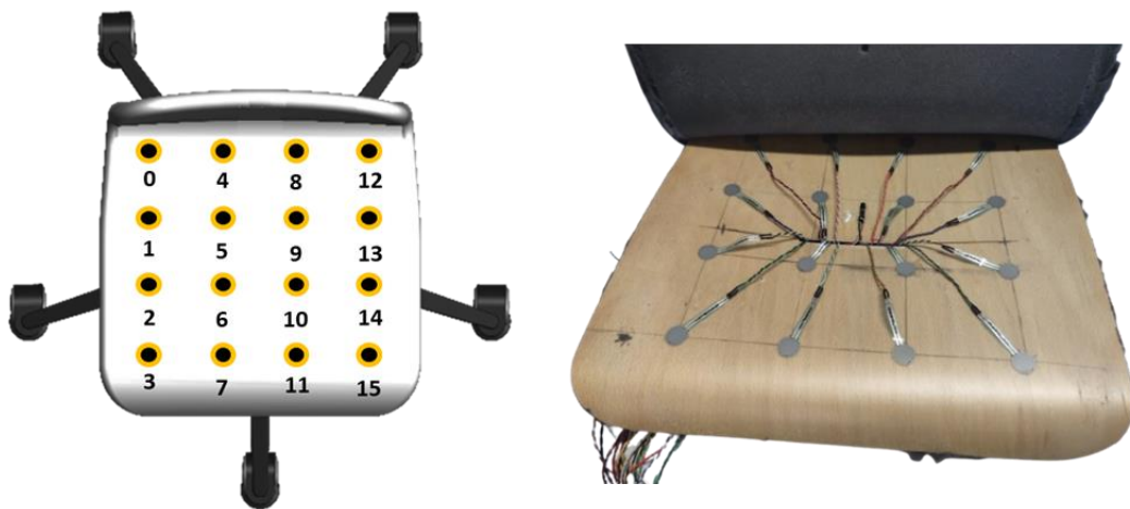
Figura 4.21 – Localização dos sensores no segundo protótipo
