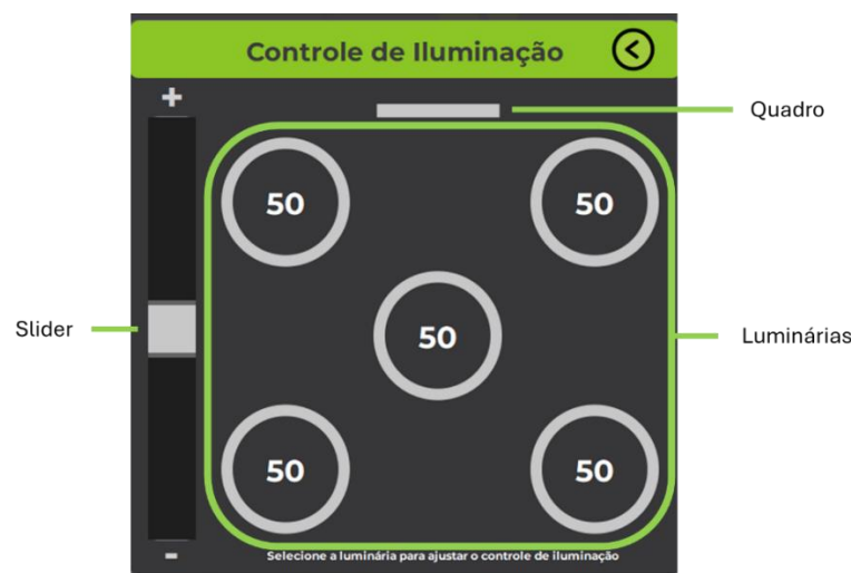
Figura 5.12 – DISPLAY: Layout do controlo de iluminação.
