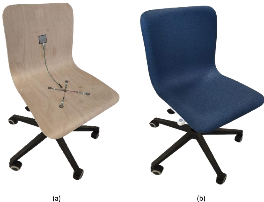
Figura 4.5 – SPMS: (a) Cadeira com os sensores colocados; (b) Cadeira após a estofagem.
